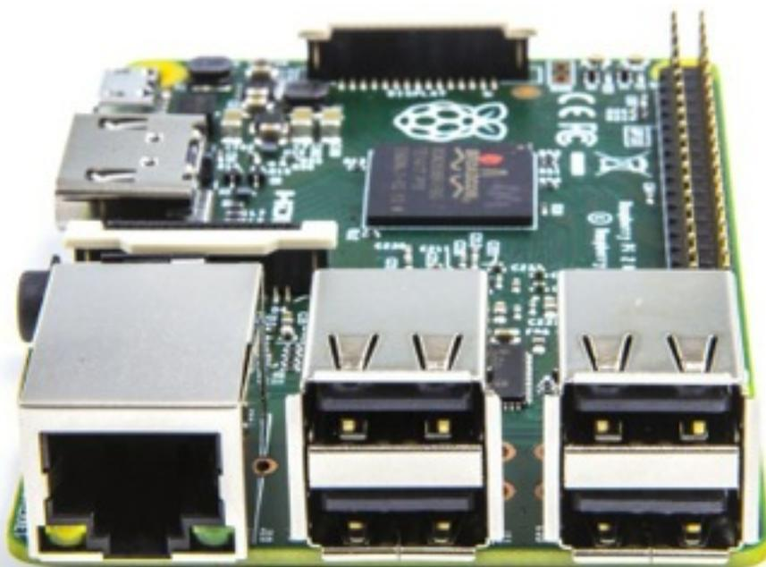
L'alimentation électrique passe par un connecteur micro-USB permettant l'utilisation d'un cordon et d'un chargeur basiques de téléphone portable.
